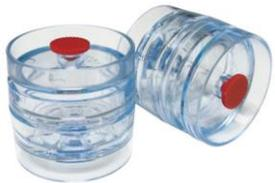
Cassette fermée 37 mm avec filtre en polycarbonate + pompe  $2L \cdot min^{-1}$
