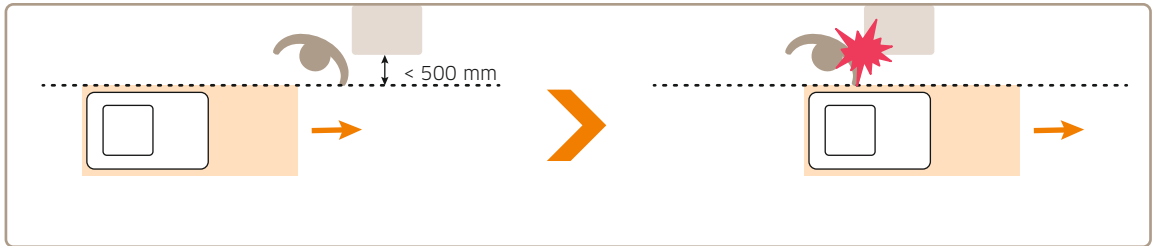
FIGURE 2 → Représentation du risque d'écrasement d'une personne entre un AMR et un objet,
