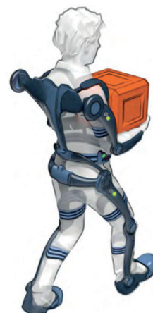
Figure 2 : Représentation d'un exosquelette actif d'assistance corps entier
