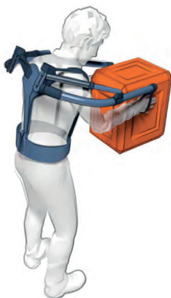
Figure 3 : Représentation d'un exosquelette passif d'assistance des membres supérieurs
