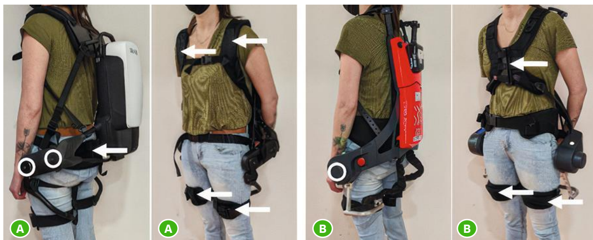
FIGURE 2 → Les deux modèles d'exosquelettes étudiés : (A) EXO1 (B) EXO2. Les articulations des exosquelettes et les points de transfert de l'assistance sont représentés respectivement par des cercles blancs et des flèches blanches.
