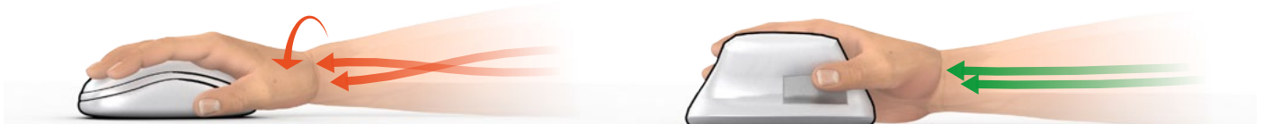
■ Figure 9. Position de l'avant-bras et du poignet suivant l'utilisation d'une souris traditionnelle ou d'une souris inclinée.
