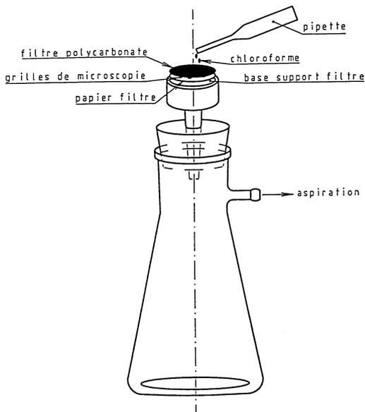
Disposer un papier-filtre sur le fritté d'un appareil de filtration.
