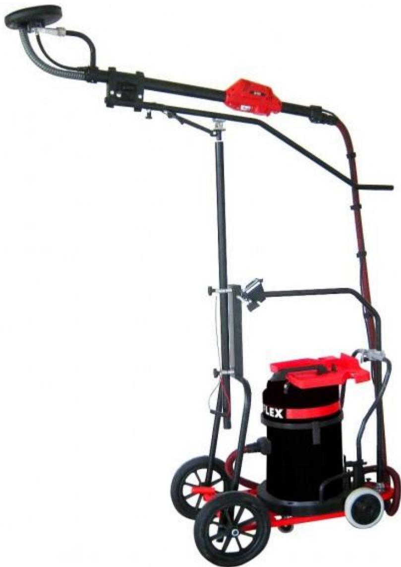
Une fois ce diagnostic réalisé, nous avons cherché ce qui pouvait nous aider. Nous avons vérifié ce qui existait déjà sur le marché, avons testé diverses machines, girafes installées sur un socle à roues avec levier qui permettait à l'opérateur, en activant celui-ci, de mettre en position la ponceuse, sans la supporter physiquement.
