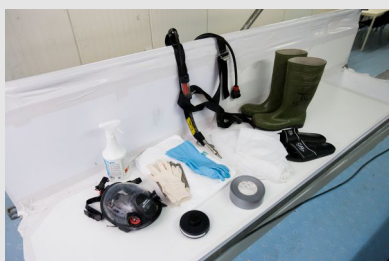
Différents éléments de protection individuelle sur un chantier de désamiantage : appareil de protection respiratoire, combinaison, gants, scotch pour l'étanchéité, harnais pour le travail en hauteur, bottes...
