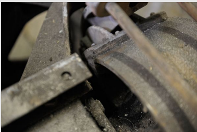
Mâchoires de frein d'un moteur d'ascenseur
