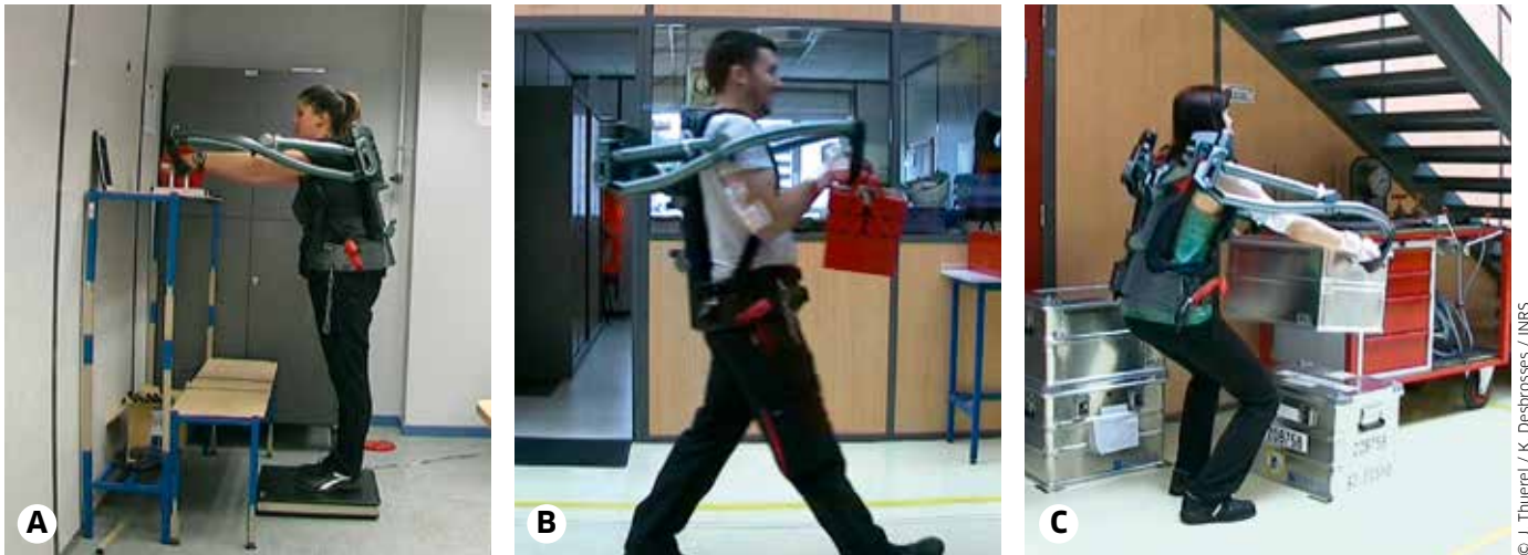
↑FIGURE 1 L'exosquelette et les trois tâches expérimentales: A) manipulation de charge standardisée (STAND) ; B) marche avec port d'une caisse à outils (MARCHE) et C) manipulation de caisses avec rotation du tronc (ROTAT).
