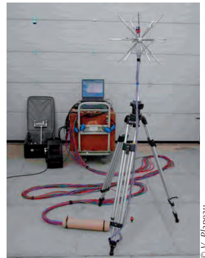
Une antenne acoustique est un assemblage de microphones répartis selon une géométrie particulière. Ce dispositif est relié à un système d'acquisition et de traitement des signaux mesurés simultanément.
