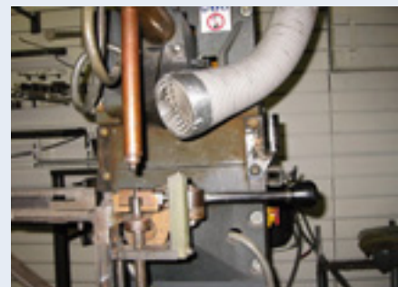
Fig. 36. Poste de soudage par points.
