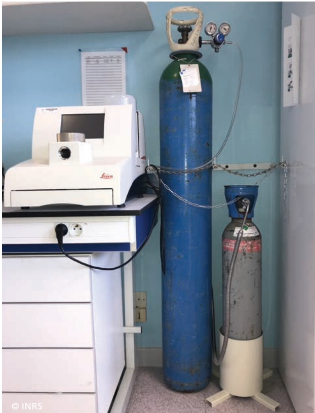
Figure 13. Aménagement au poste de travail : la bouteille est fixée par une chaîne ou placée dans un support de pied
