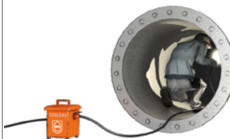
FIGURE 18. La protection par TBTS doit être utilisée dans les enceintes conductrices exigües.
