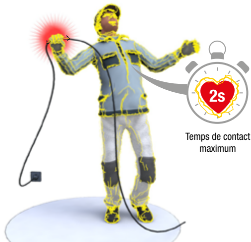
FIGURE 10. Le temps de passage du courant dans le corps humain : un facteur important. Par exemple, au delà de 2 s, un courant de 10 mA est dangereux.
