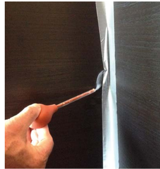
Figure 4. Vérification de l'étanchéité des jointures du caisson à l'aide de fumée.
