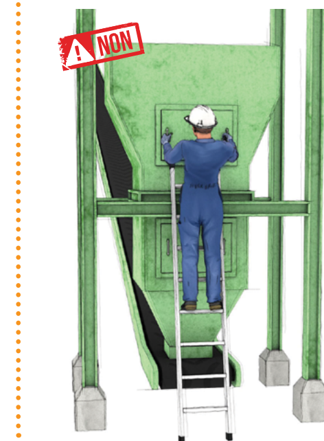
Figure 2. Situation à risque lors de l'opération de débouillage des cribles
