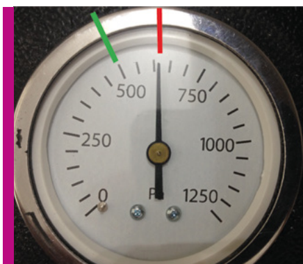
Figure 3. Exemple de repère en rouge sur manomètre suivant configuration n° 2
