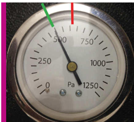
Figure 2. Exemple de repère en vert sur le manomètre suivant la configuration n° 1
