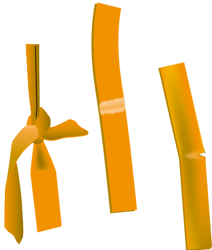
■ Figure 43. Principaux défauts présents sur une sangle de levage
