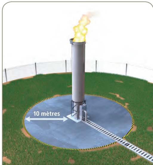
Figure 6. Torchère et zone de sécurité associée
