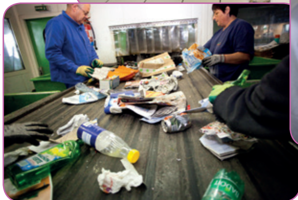
Cabine de tri de déchets
