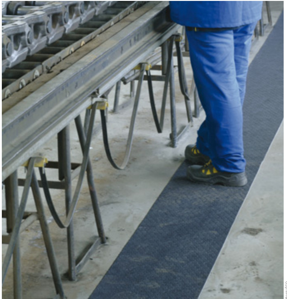
Figure 4. Rouleaux d'absorbant synthétique utilisés en préventif pour la protection des sols dans une usine
