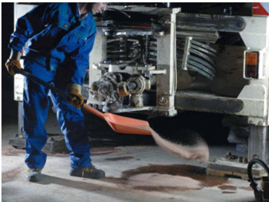
Figure 1. Épandage à la pelle de granulés d'absorbant naturel minéral calciné
