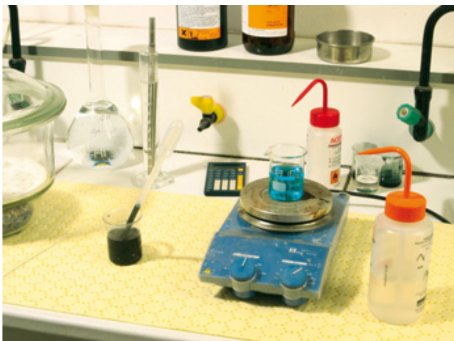
Figure 2. Feuilles d'absorbant synthétique utilisées en préventif sur une paillasse de laboratoire
