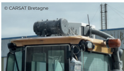
Dispositif de pressurisation de d'air de la cabine de l'engin, doté de filtre THE
