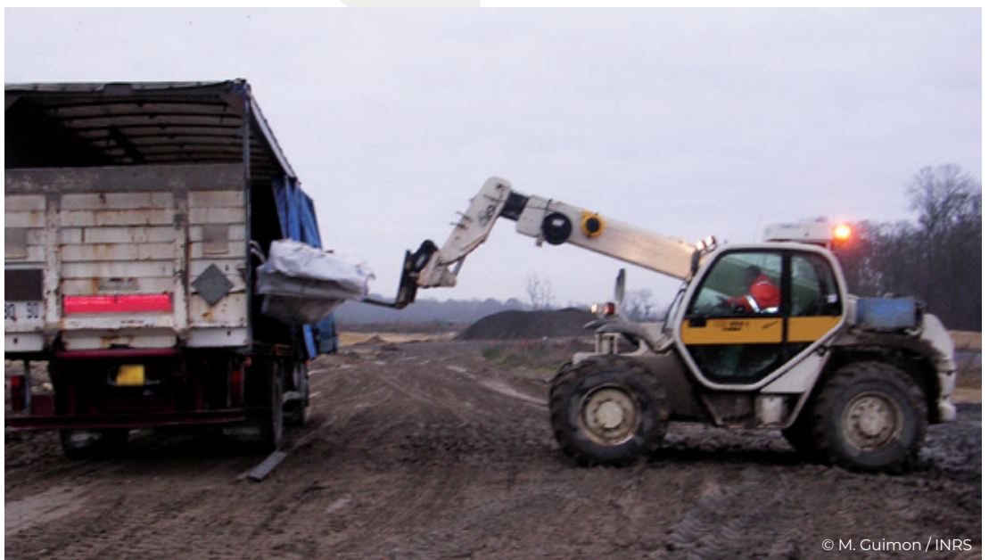
Déchargement de plaques d'amianté-ciment à l'aide d'un engin de manutention à cabine pressurisée
