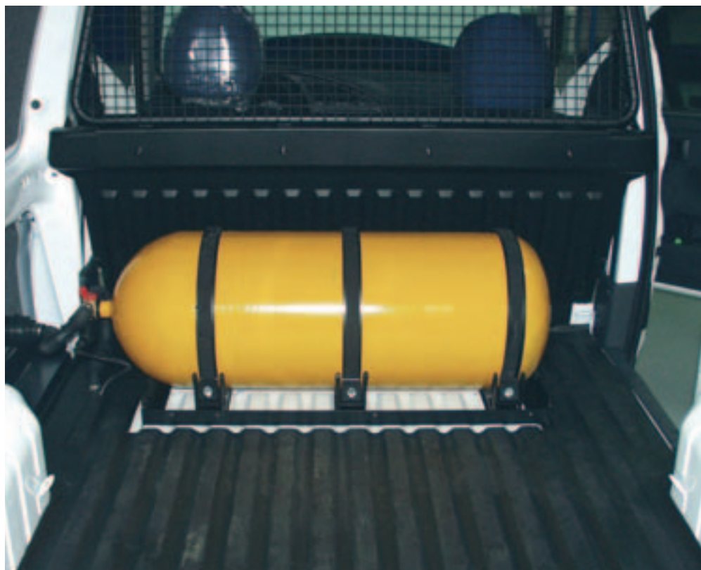
Réservoir GNV installé dans un véhicule utilitaire (le capot de protection ayant été retiré).
