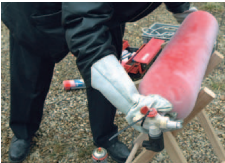
Opérateur équipé de gants manipulant un réservoir givré.
