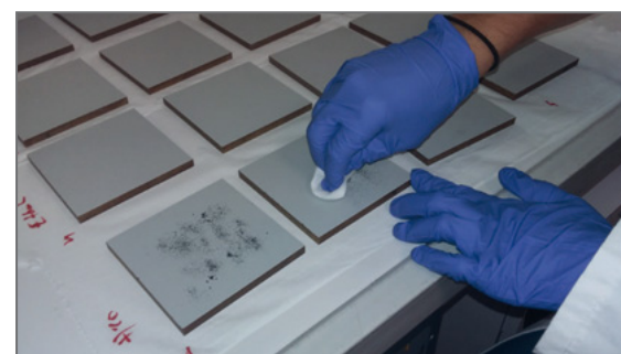
Figure 2 : Exemple de mise au point de méthode de prélèvement par essuyage afin de déterminer le liquide d'imprégnation des lingettes conduisant à un rendement de récupération optimal.
