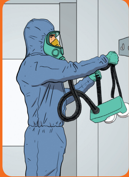
2. Suspendre le bloc moteur.
