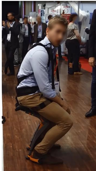
Figure 23. Dispositif d'assistance physique membres inférieurs (©INRS/ Gobio-Robot)
