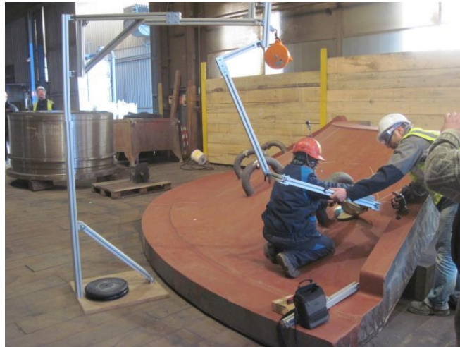
Figure 27. Simulation de l'activité future à l'aide d'une maquette en profilés aluminium échelle 1 (Crédits Ferry Capitain)
