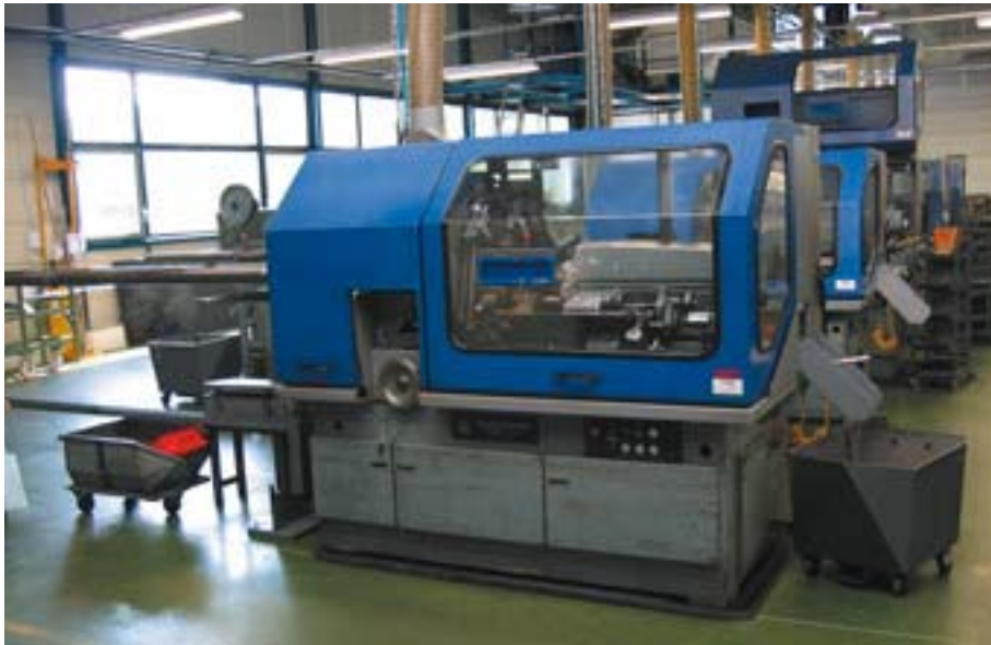
Photo 1. Dispositif de captage enveloppant sur tour à décolleter.
