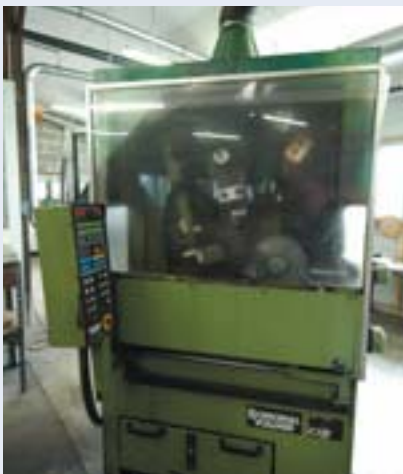
Photo 7. Affûteuse avec capotage complet.
