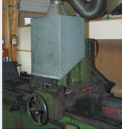
Photo 8. Rectifieuse avec capteur mobile.
