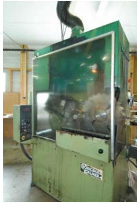
Photo 2. Dispositif de captage fermé avec ouverture de section faible.
