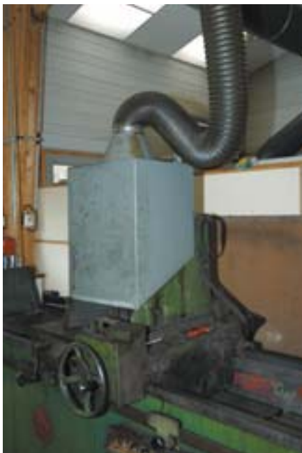
Photo 3. Rectifieuse avec capteur.
