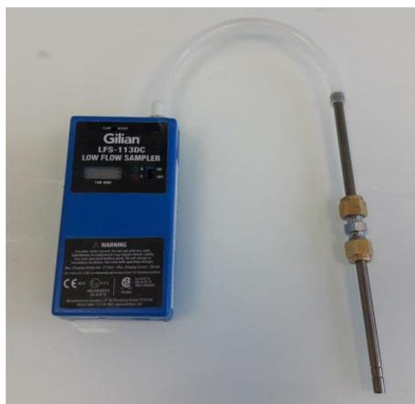
Les deux tubes sont reliés par une union 1/4" et des noix de serrage Swagelok équipées de ferrules en Téflon®.
