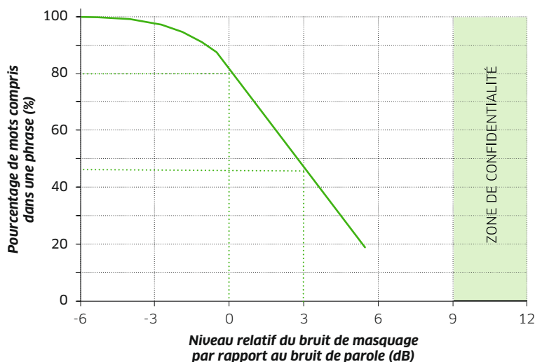
↑ FIGURE 2 Intelligibilité en fonction du niveau relatif de bruit de masquage (selon la norme NF EN IEC 60268-16 [2]).
