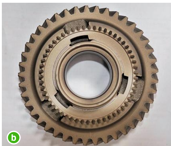
↑ FIGURE 9 Pignon de boîte de vitesse automobile en acier 23MCD5 : (a) brut et (b) cémenté : m ~ 1,5 kg.
