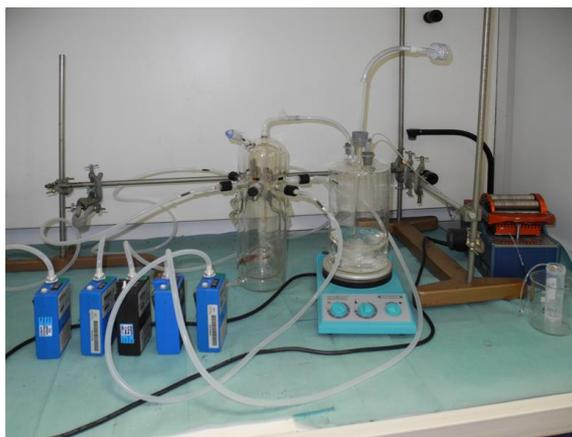
Photographie 1 : Exemple de montage pour le dopage des tubes Hg : génération de vapeur froide de mercure vers une cellule de mélange équipée de six points de prélèvement
