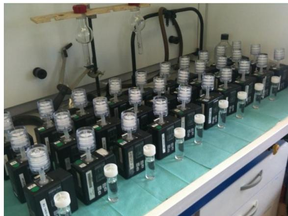
Photographie 2 : Exemple de montage pour le dopage de cassettes NH<sub>3</sub> : dépôt d'une solution de NH<sub>3</sub> sur un préfiltre amont et aspiration d'air à travers ce préfiltre vers les filtres imprégnés en aval pour collecter les vapeurs de NH<sub>3</sub> générées par évaporation de la solution.
