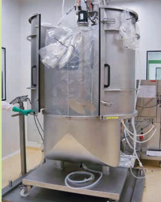
que les deux orifices de cette double enveloppe sont complètement ouverts. Lorsque le constructeur préconise de remplir à moitié d'eau la double enveloppe, il convient de s'assurer que l'orifice supérieur est bien ouvert et que l'orifice inférieur est bien fermé.
