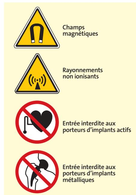
Figure 1. Signalisation à mettre en place à proximité des installations émettant des champs électromagnétiques importants
