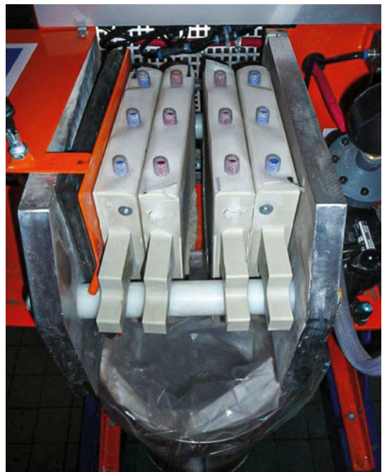
■ Figure 39. Filtre presse pour augmenter la siccité des boues décantées contaminées
