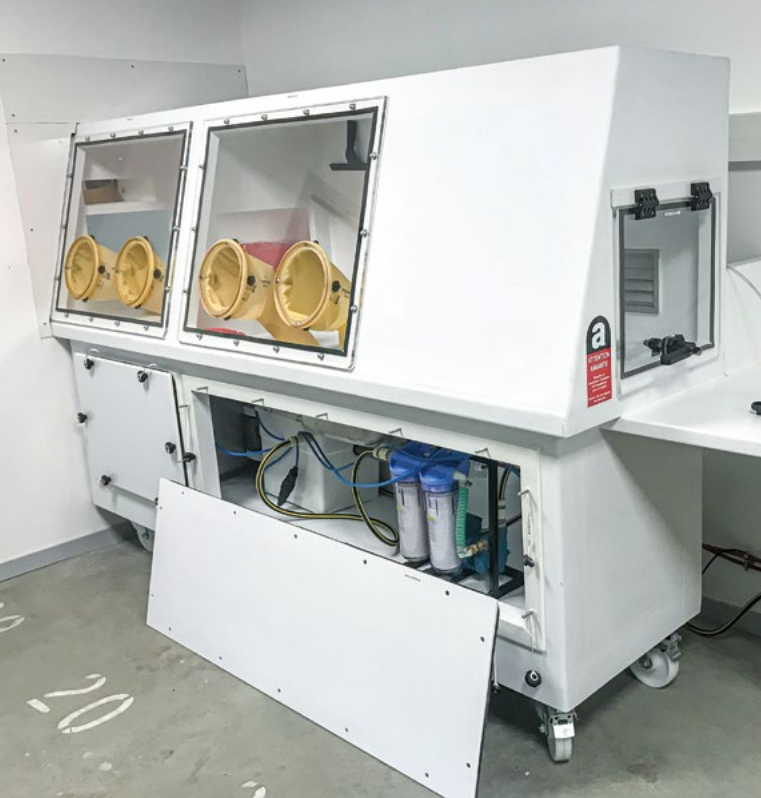
■ Figure 17. Partie «désemballage, démontage, lavage, séchage» d'une unité de traitement du petit matériel
