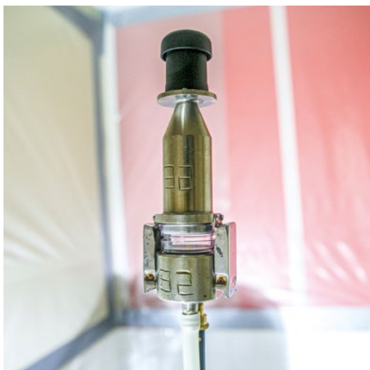
■ Figure 31. Tête CAThia de prélèvement d'ambiance pour analyse de restitution du matériel après sa décontamination
