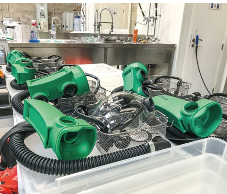
■ Figure 19. Matériel décontaminé et libéré, prêt à être remonté dans la zone de remontage
