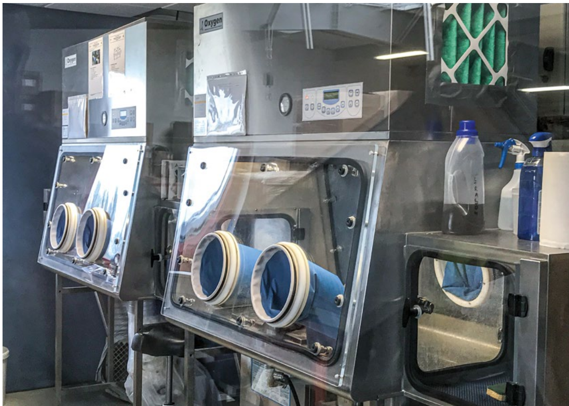
■ Figure 10. Unité de traitement «boîte à gants» équipée d'un dispositif de type Longopac sous paillasse pour la récupération des emballages contaminés
