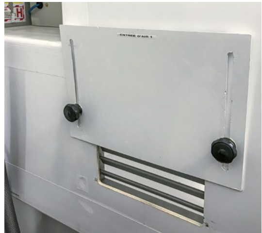
■ Figure 7. Entrée d'air de réglage sur une unité de traitement du petit matériel
