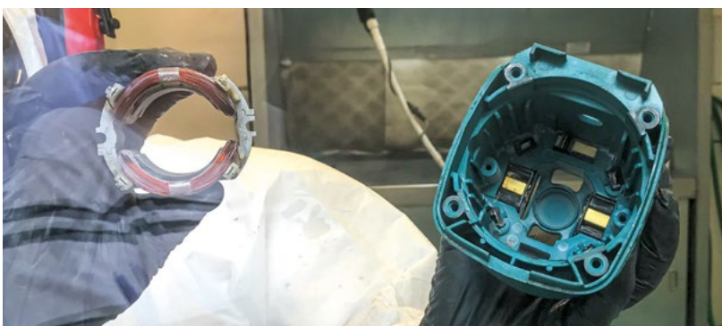
■ Figure 25. Intérieur du moteur après décontamination au CO 2 par cryogénie
