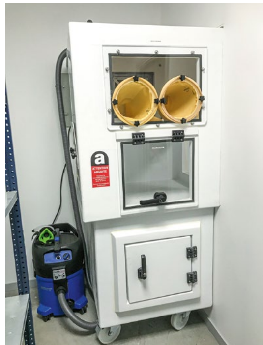
■ Figure 16. Écluse « entrée matériel » du petit matériel Les manches en position haute permettent le changement en sécurité des préfiltres des extracteurs.
