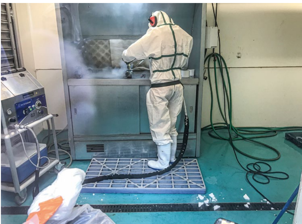
■ Figure 24. Décontamination du moteur d'un équipement électroportatif au CO 2 par cryogénie dans une installation dédiée ; présence de morceaux de glace au sol
