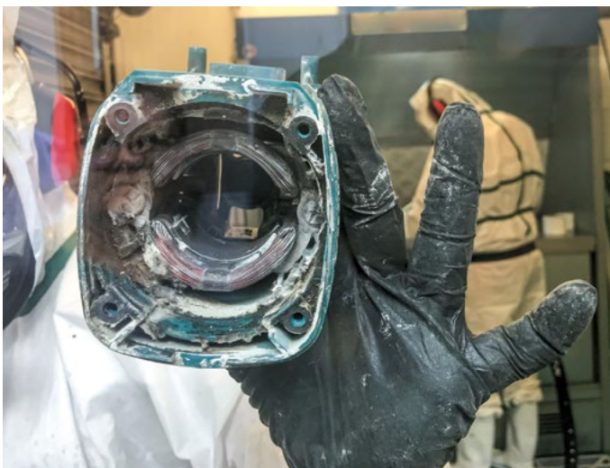
■ Figure 23. État d'encrassement de l'intérieur du moteur d'un équipement électroportatif avant décontamination au CO 2 par cryogénie
