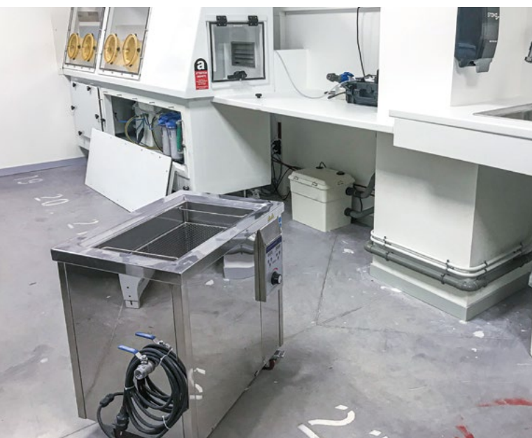
■ Figure 22. Cuve à ultrasons mobile pouvant être placée dans un endroit éloigné de la zone de travail de l'opérateur lorsqu'elle n'est pas intégrée dans la zone de lavage de l'unité de traitement
