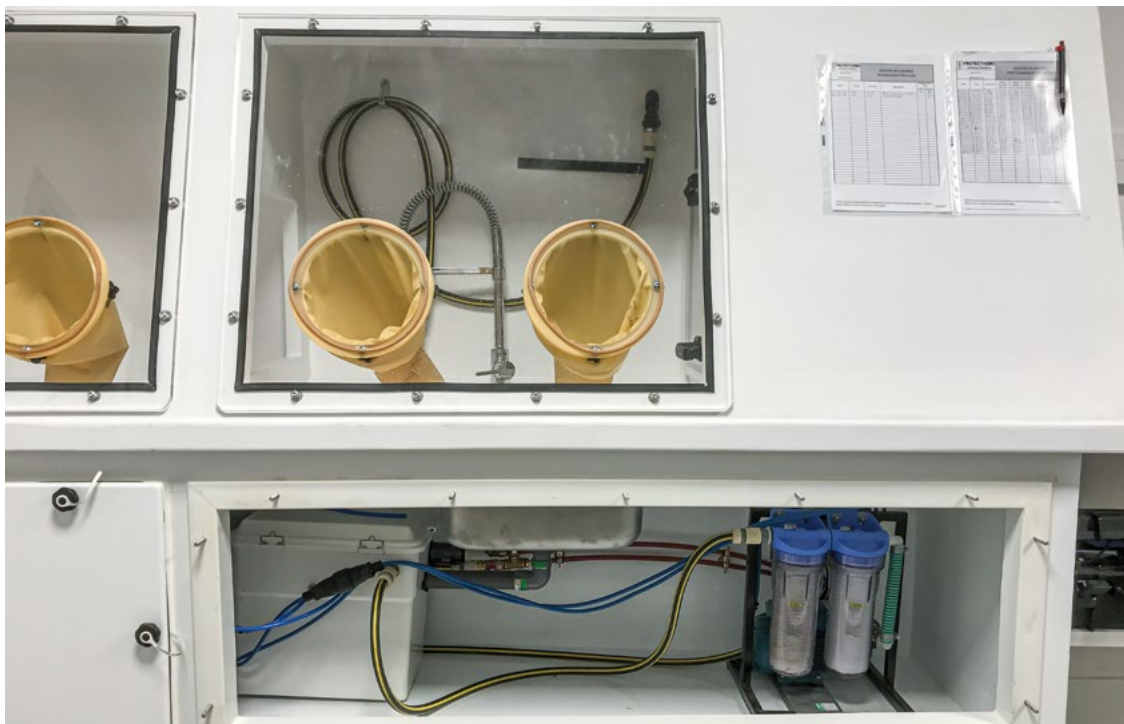
Figure 12. Accessibilité du dispositif de filtration de l'eau sous l'unité de traitement du petit matériel permettant le changement des filtres
