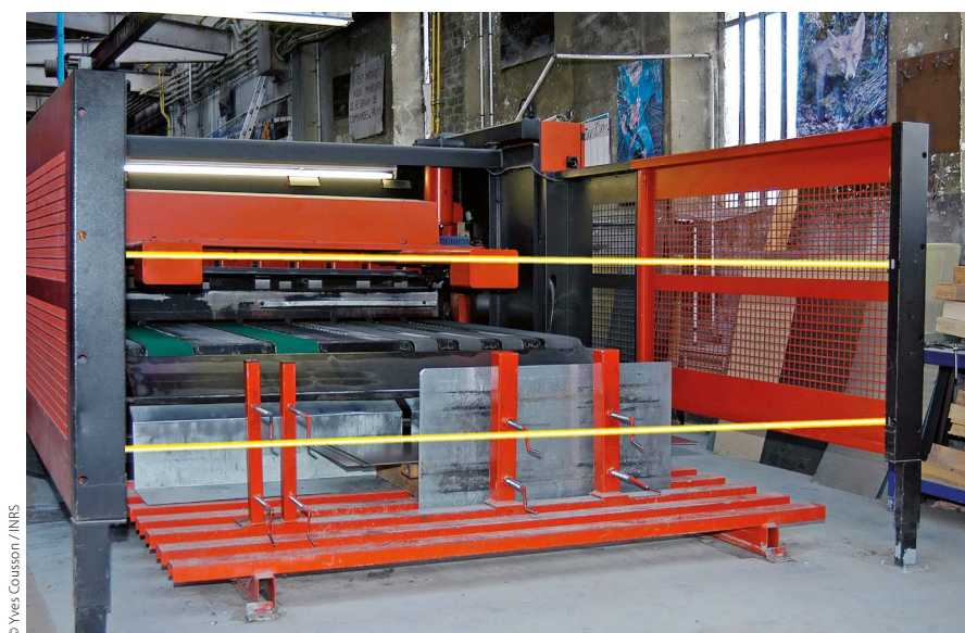
Figure 9. Protection immatérielle de la zone arrière d'une cisaille guillotine
