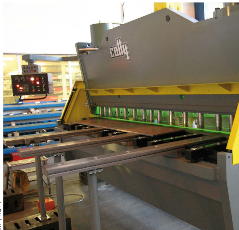
Figure 5. Exemple de barrière immatérielle installée sur une machine neuve
