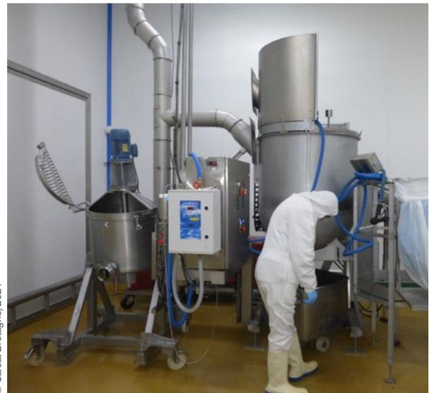
■ Caisson et cuve de mélange en position haute
