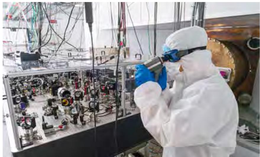
Banc optique générant le laser infrarouge initial de l'interféromètre Virgo, au laboratoire CNRS de Physique des particules d'Annecy-le-vieux. →
