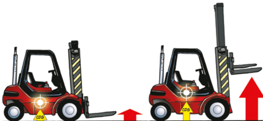
Figure 1. Élever la fourche décale le centre de gravité (CDG) vers le haut, même à vide, diminuant la stabilité de l'engin
