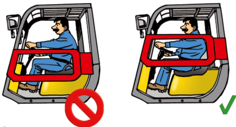
Figure 2. Montage optimal d'un portillon par rapport à la morphologie du cariste
