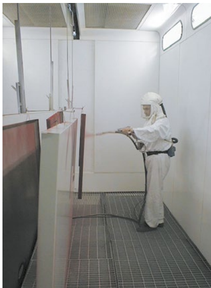
Peintre poudrant des pièces dans une cabine fermée à ventilation verticale.
