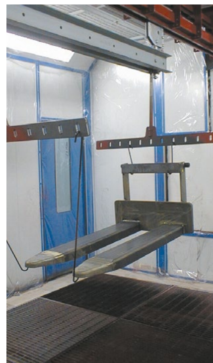
Subjectile en attente de poudrage dans une cabine fermée à ventilation verticale.
