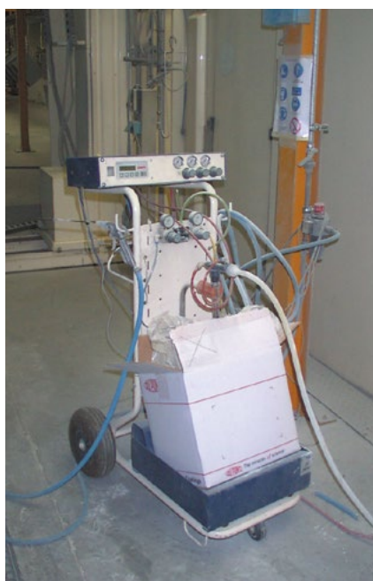
Divers dispositifs d'alimentation en poudre. En haut, la zone de fluidisation est ventilée. À gauche, la fluidisation a lieu directement dans le conditionnement d'origine, ce qui évite le transvasement.
