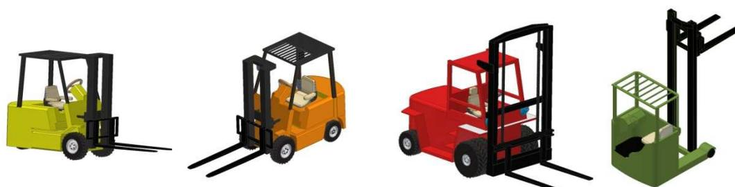
Figure 1 : Exemples de chariots de manutention : chariots frontaux à 3 ou 4 roues, chariot de chantier, chariot à mât rétractable.
