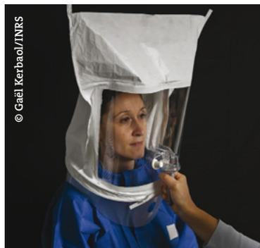
Figure 3 : Réalisation d'essai d'ajustement qualitatif [4]
