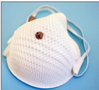
Pour les demi-masques et masques complets, un adaptateur de dimension adéquate doit être utilisé (figure 5). Cet adaptateur doit être retiré à la fin de l'essai. Pour l'essai, les masques sont équipés d'un filtre P3. Les masques des appareils à ventilation assistée et à adduction d'air sont également testés en les équipant d'un filtre P3 à la place du système d'alimentation en air.
