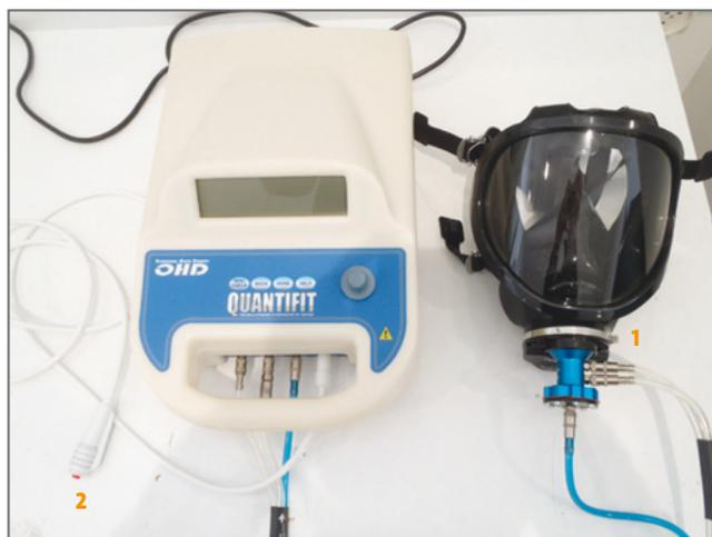
1. Adaptateur 2. Bouton déclencheur du test
