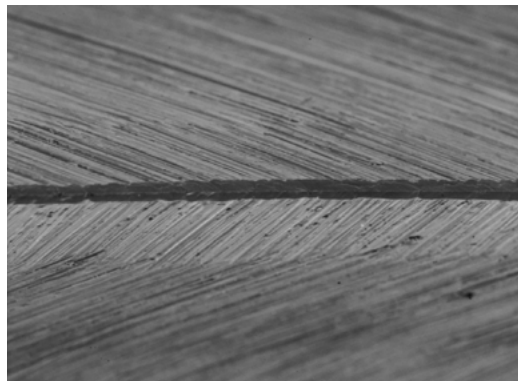
Figure 26. Vue de dessus – État de surface du taillant avec roues hélicoïdales traditionnelles grain 400
