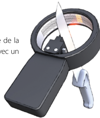
Figure 29. Laser-goniomètre (mesure des taillants de couteaux de découpe)
