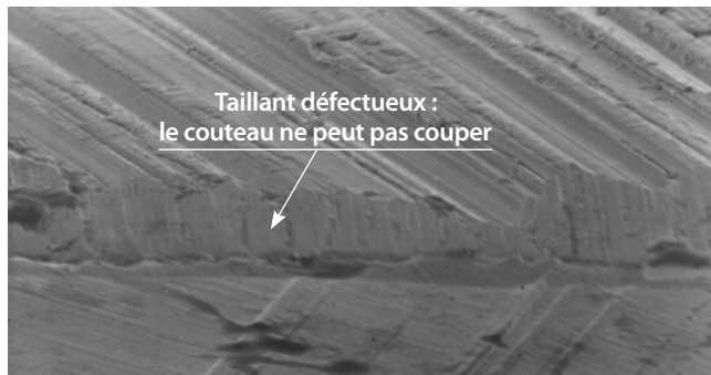
Figure 31. Couteau neuf au taillant défectueux
