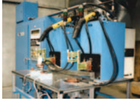
Photo 6. Inducteurs pour le chauffage de pièces avant brasage.
