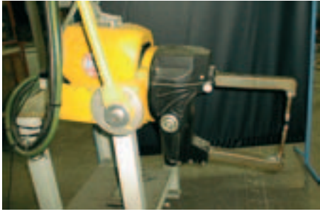
Photo 4. Pince de soudage par point à transformateur intégré.
