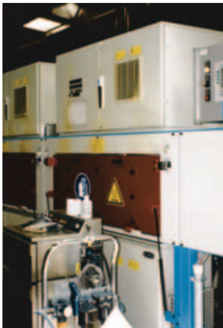
Photo 9. Four à micro-ondes industriel pour la vulcanisation du caoutchouc.
