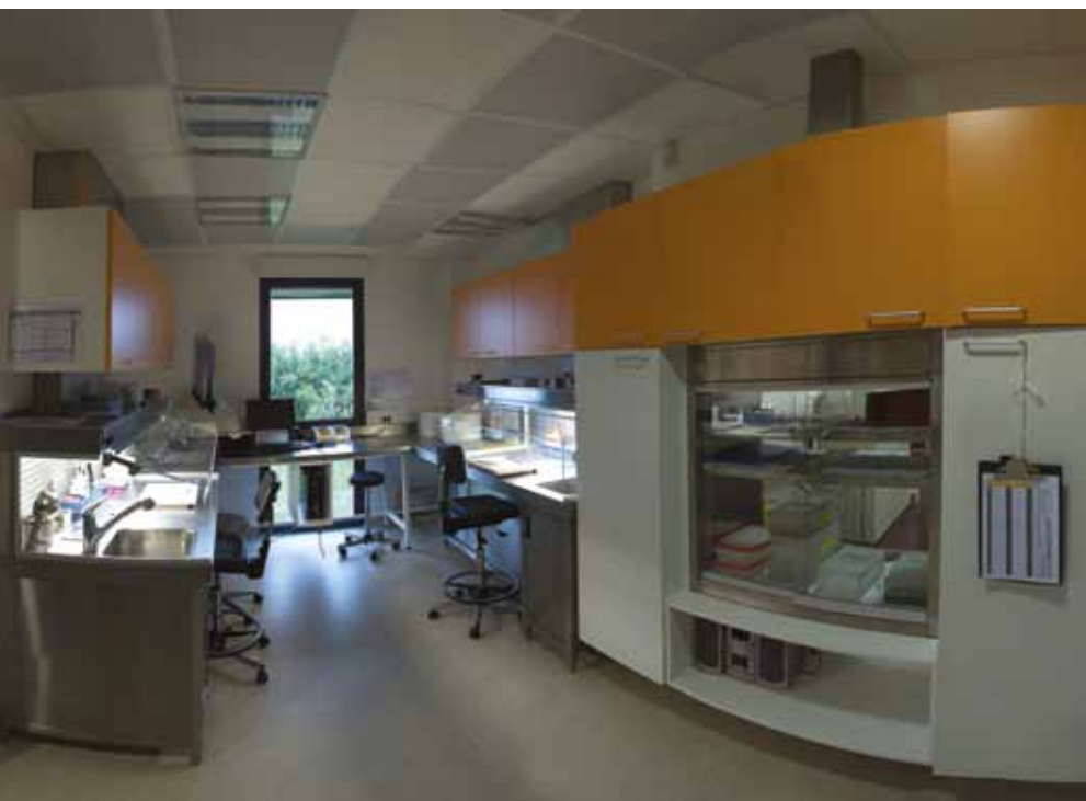
Le local de macroscopie avec l'armoire ventilée transmurale entre la réception et la macroscopie
