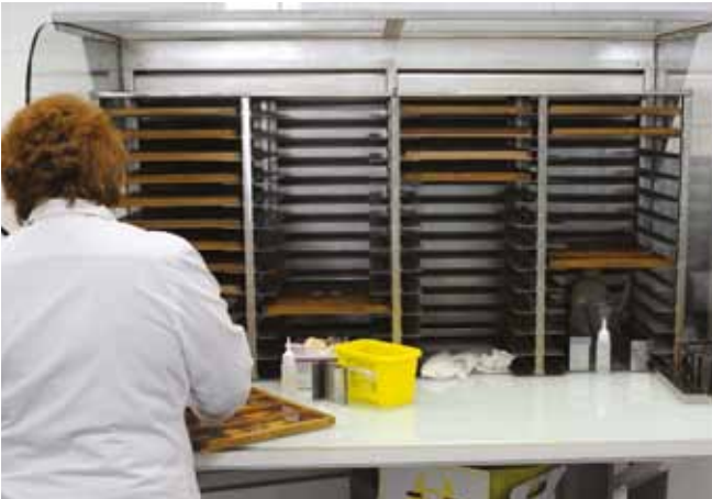
Enceinte ventilée de séchage des lames
