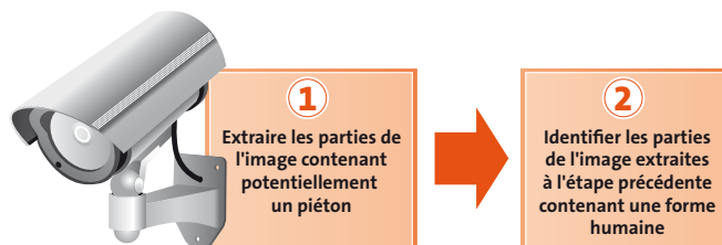
Figure 1 – Illustration du principe de fonctionnement d'un capteur basé sur la vision numérique
