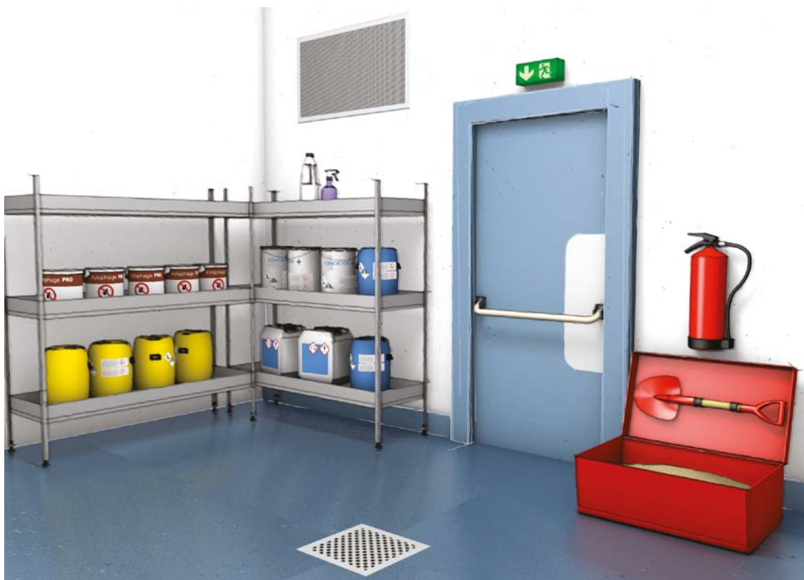
Figure 12. Local de stockage des produits chimiques
