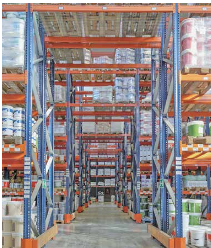
Installation avec allée pont
