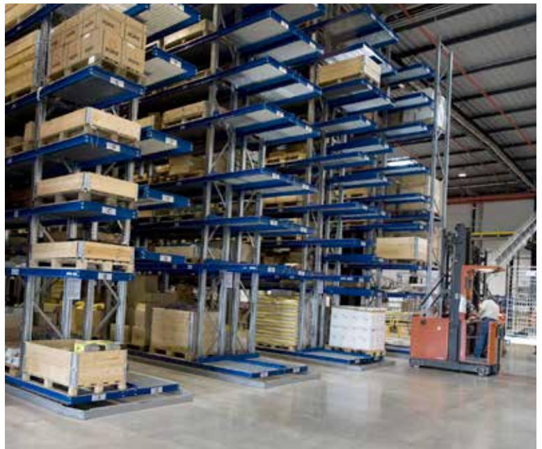
Installation de stockage desservie par chariots à guidage latéral
