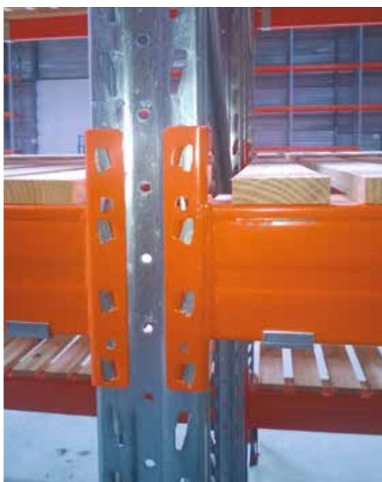
Liaison lisse/montant avec goupille
