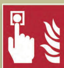
Point d'alarme incendie
