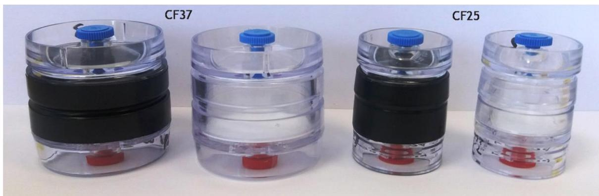
Figure 5 : Exemples d'aspects de CF37 et CF25 après montage. Le ruban adhésif noir apposé sur deux CF est optionnel ; il peut permettre de limiter le dépôt de particules sur les surfaces (rainures) extérieures.
