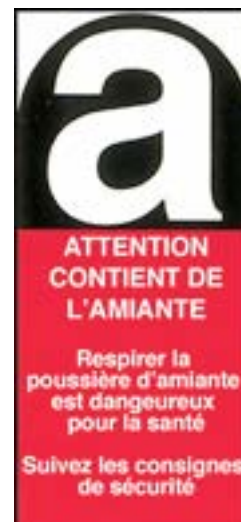
Étiquetage réglementaire amiante
