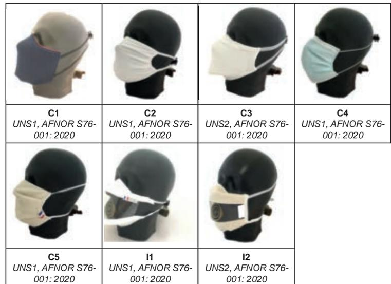
Figure 3 : Illustration des modèles de masques chirurgicaux jetables testés et certification.
