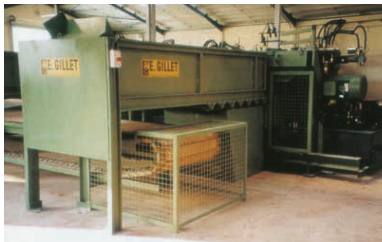
Figure 22. Sur l'arrière de la machine, tunnel et bouclier d'extrémité
